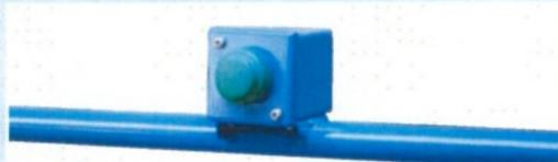
押しボタンスイッチを押している間はブラシが回り、シャワーリング。指を離すと自動的にストップ。ボタンひとつで洗浄時間が調節できますので、ひどい汚れにも対応。必要ときに必要なだけ使えるムダの少ない省エネタイプです。
